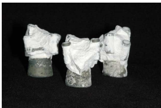
Figura 6 - Início da desinclusão dos corpos de prova, ainda cobertos em parte pelo revestimento
