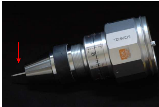
Figura 12 - Torquímetro com chave bidigital adaptada em sua extremidade inferior (seta)
