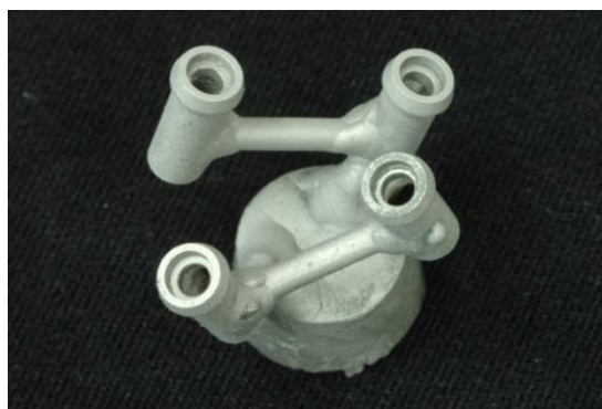
Figura 7 - Corpos de prova após a desinclusão e limpeza por jateamento, antes dos cortes dos condutos de alimentação
