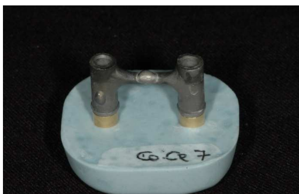
Figura 8 - Vista frontal da peça após soldagem com solda convencional
