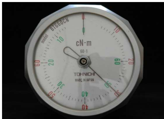
Figura 13 - Vista superior do torquímetro. Agulha cega mostrando a quantidade de Newtons obtida
