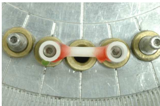
Figura 5 - Vista oclusal do padrão para fundição preparado no dispositivo
