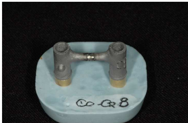
Figura 9 - Vista frontal da peça após soldagem com solda TIG
