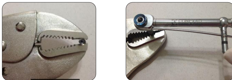
Figura 3: Alicata de pressão, servindo de apoio para instalação e torque dos pilares no implante. Fonte: O autor.
