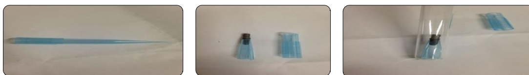
Figura 4: As imagens mostram a sequência de preparo ponteira da pipeta para que sirva de apoio ao implante já com os pilares de forma que esse conjunto fique ereto dentro do tubo de ensaio para afim de não se contaminar a entrada da cabeça do parafuso dos pilares. Fonte: O autor.
