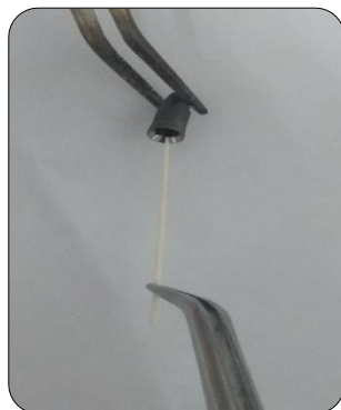
Figura 7: Colheita de material na junção pilar implante de cada conjunto para semeadura na placa de Muller Milton. Fonte: O autor.
