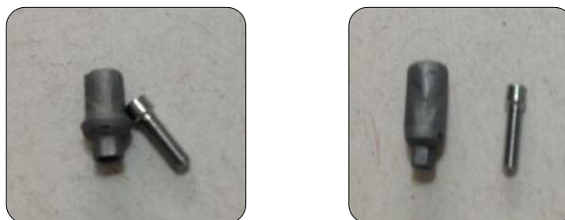
Figura 1: Pilares UCLAS totalmente calcinável, e parcialmente calcinável, após preparação e fundição laboratorial com liga de Ni Cr. Fonte: O autor.
