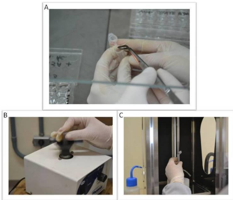
Figura 3 – A – Remoção dos corpos de prova das placas de incubação, colocados em tubos contendo 1 mL de solução salina; B – Corpos de prova sendo submetidos a agitação em vortex; C - Corpos de prova sonicados para obtenção de suspensão homogênea de biofilme.
