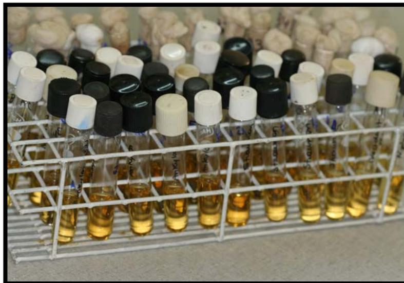
**Figura 4.7.** Todos os 35 implantes já incluídos por 30 segundos no tubo controle e imersos no tubo teste (prontos para serem levados à estufa).
