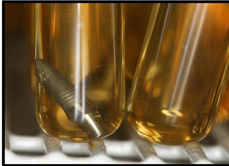
**Figura 4.6.** Implante imerso em tubo de ensaio com meio de cultura, e tubo controle da contaminação externa após 30 segundos de imersão.
