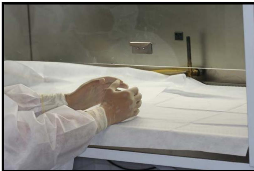
**Figura 4.2.** Operador com capote e luvas estéreis e o interior da capela de fluxo laminar forrada com campos estéreis
