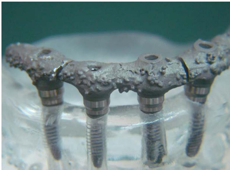
Figura 16 - Barra seccionada na mesial dos implantes distais.
