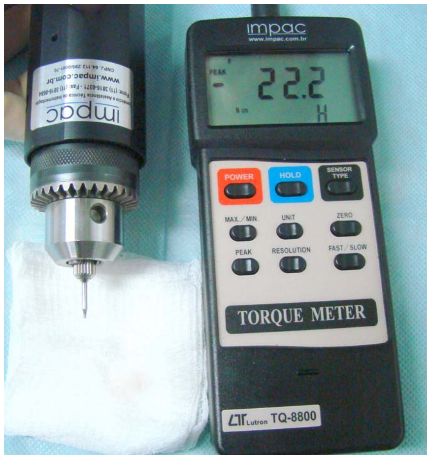
Fotografia 10: Torquímetro Digital Lutron® TQ-8800.
