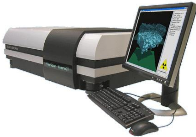
Figura 9: Micro tomógrafo de bancada (SkyScan 1172).
