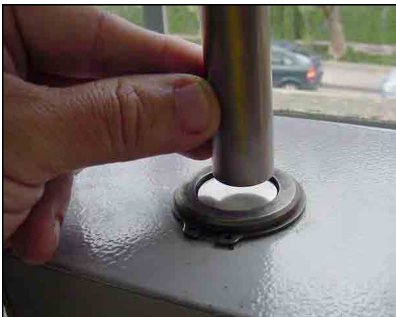
FIGURA 19-Pino é posicionado para local central da câmara de aquecimento
