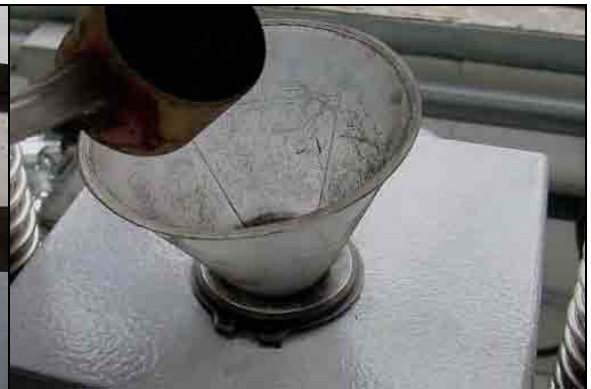
FIGURA 18-O Baquelite em pó é colocado para dentro da câmara
