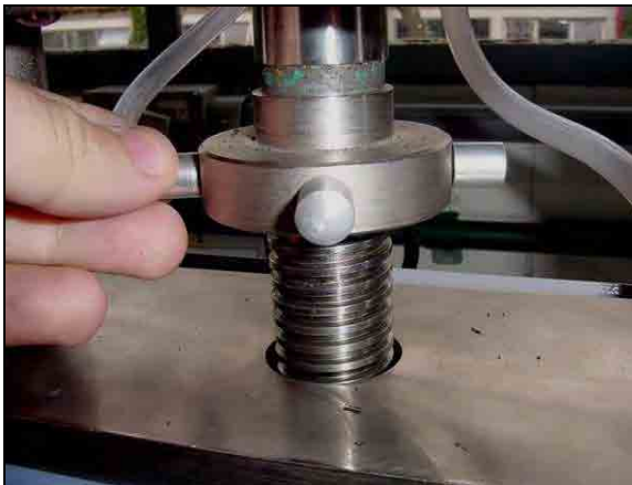
FIGURA 21- Remoção da base para expor a amostra, girando a manopla
