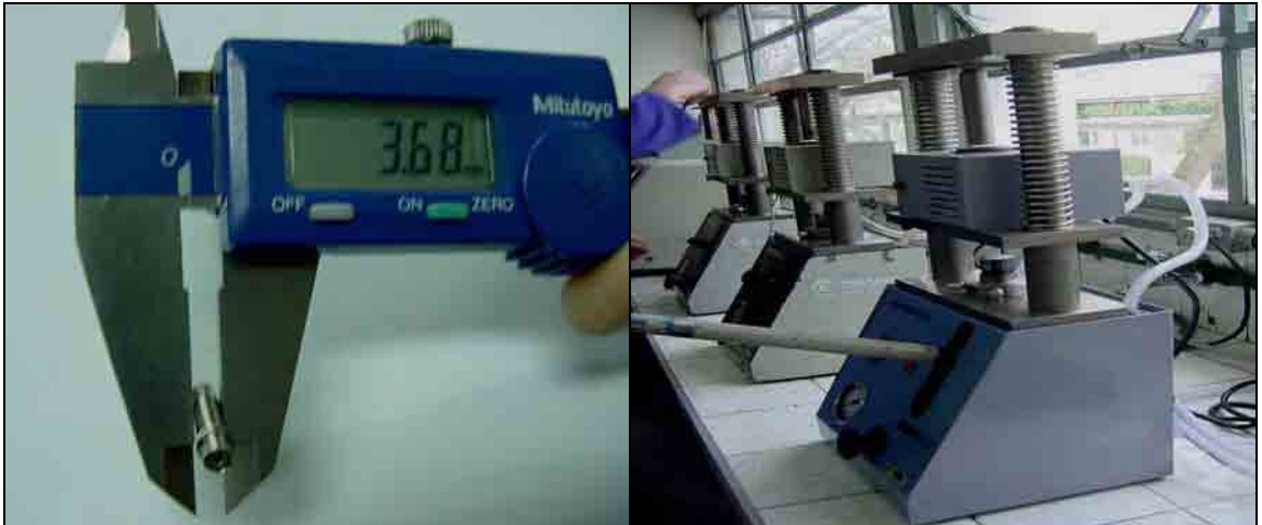
FIGURA 13-Medição da amostra com paquímetro
