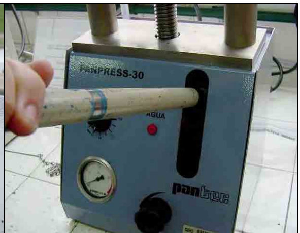
FIGURA 20-Operador eleva a pressão da câmara, de 10 a 15Kgf
