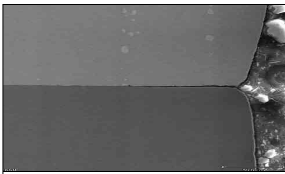
FIGURA 32-Implante Neodent com abutment gold ucla - amostra 2. Aumento 500x
