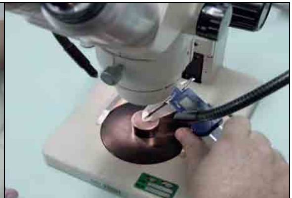
FIGURA 24- Checagem do diâmetro da amostra
