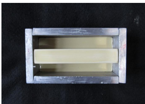
Figura 5 - Confeção da base do bloco
