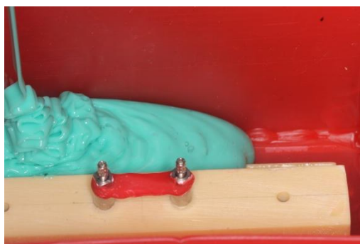
Figura 24 - Silicone sendo vertido dentro da caixa molde
