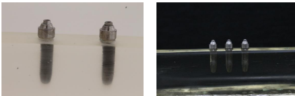
Figura 25 - Blocos de fotoelasticidade com os implantes em posição.
