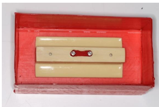
Figura 23 - Caixa molde em cera contendo o bloco de poliuretano
