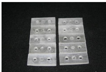
Figura 11 - Estrutura em resina acrílica para o bloco 2
