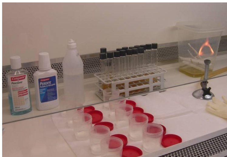
Figura 2 - Organização da câmara de fluxo, com os tubos de ensaio contendo os discos contaminados, as substâncias empregadas na desinfecção e os potes coletores universais onde os discos foram submersos
