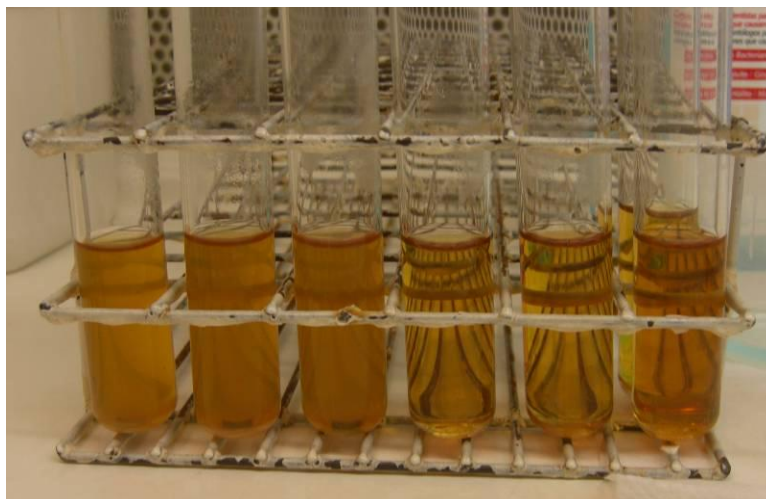
Figura 3 - Discos mergulhados em meio BHI. Os três tubos da esquerda apresentam o meio turvado, significando grande proliferação bacteriana; nos três tubos da direita, o meio estéril apresenta-se límpido
