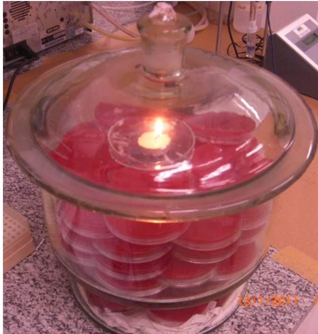
Figura 7 - Jarra de CO 2 com as placas e a vela para consumir o oxigênio simulando o ambiente de anaerobiose
