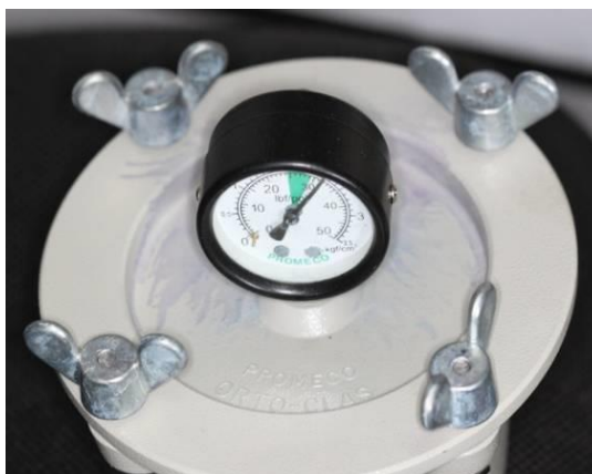
Figura 16 - Mufla adaptada para receber o ar comprimido.
