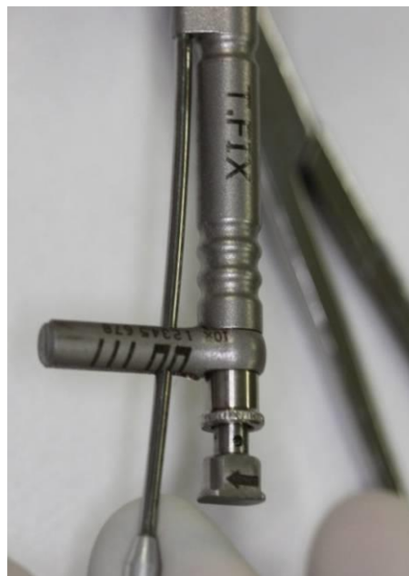
Figura 8 - Torquímetro manual Titaniumfix - 20N nos corpos de prova.
