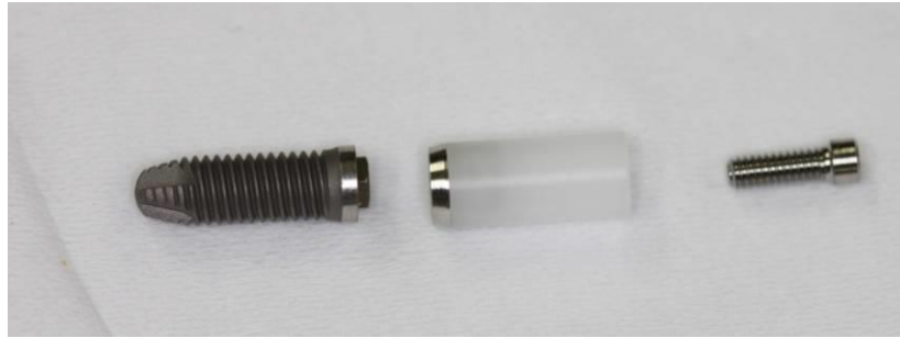
Figura 6 - Corpo de prova IT sem PTFE (politetrafluoretileno).
