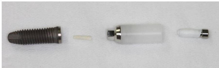
Figura 7 - Corpo de prova HI com PTFE (politetrafluoretileno).
