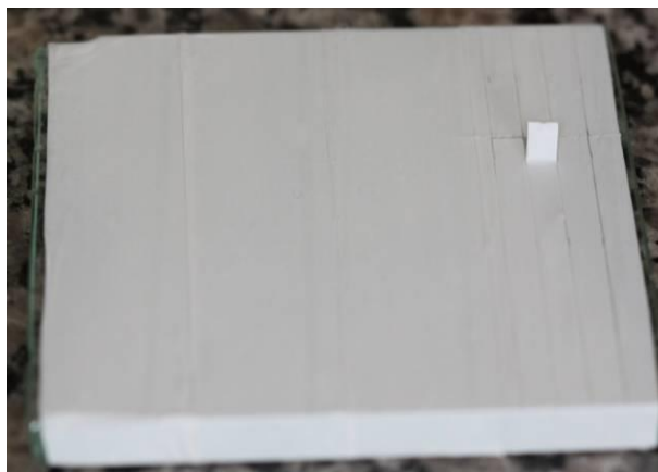
Figura 12 - Tiras de PTFE (politetrafluoretileno).
