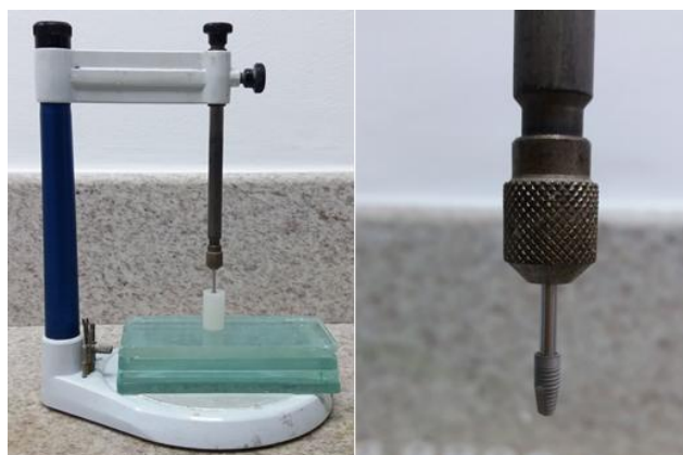
Figura 1: Inclusão do implante na forma cilíndrica com resina acrílica com auxílio de um delineador.
