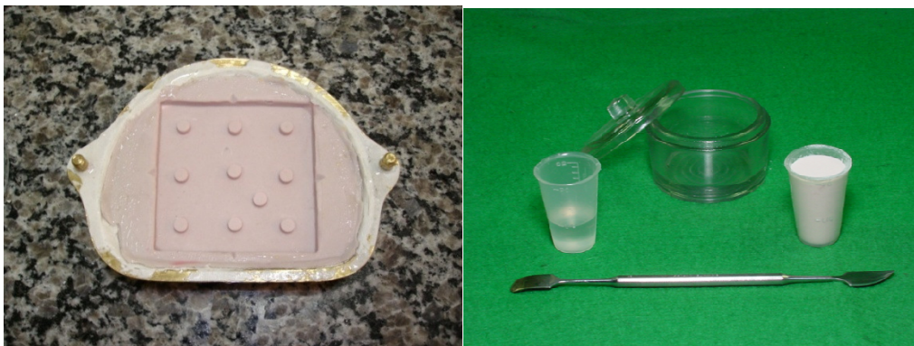
Figura 2. Mufla com molde para confecção do dispositivo de resina acrílica incolor para contenção dos discos de implante.
