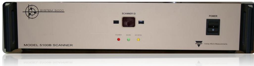
Figura 13 – Condicionador de sinais Vishay 5100B
