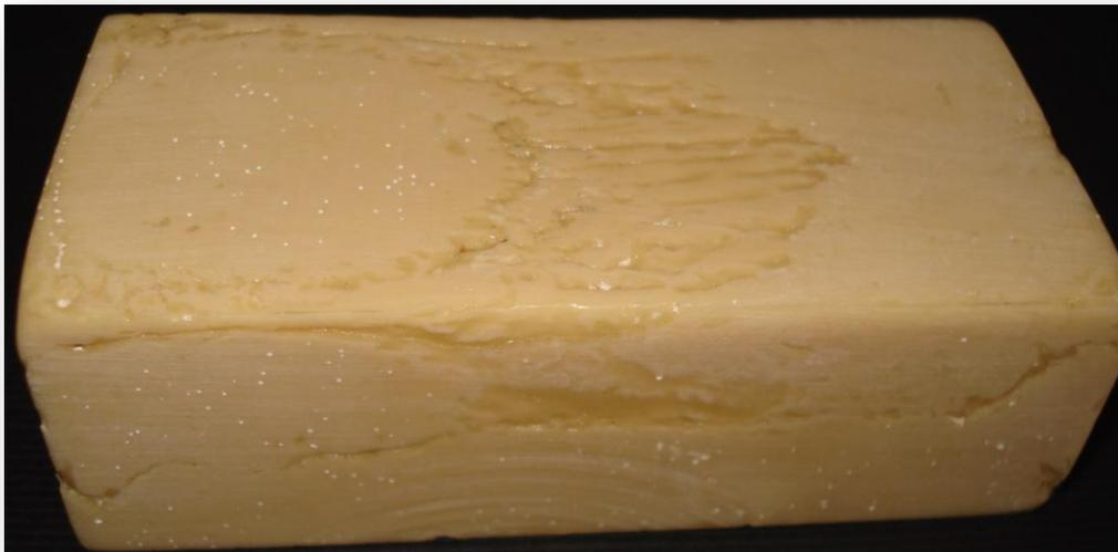
Figura 1 – Bloco de poliuretano após desinclusão
