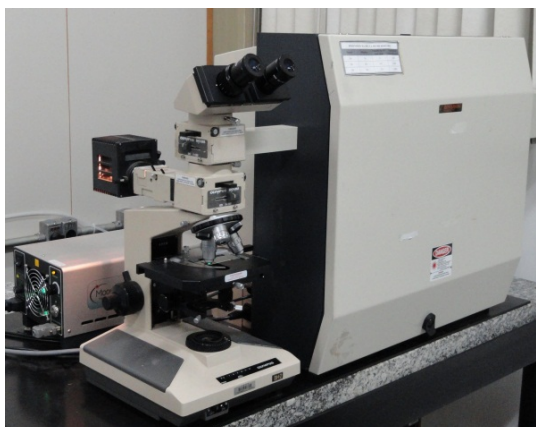
Figura 12 – Equipamento usado para a análise de espectroscopia de retroespalhamento Raman.
