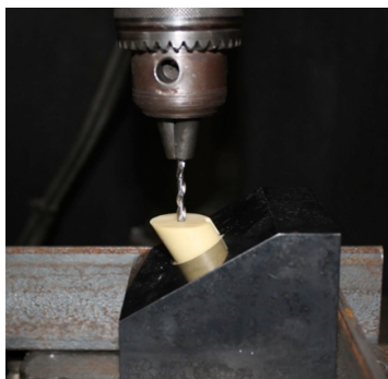
Figura 20 – Realização das perfurações do bloco de poliuretano posicionado no interior da matriz metálica fixada à base da furadeira de bancada.
