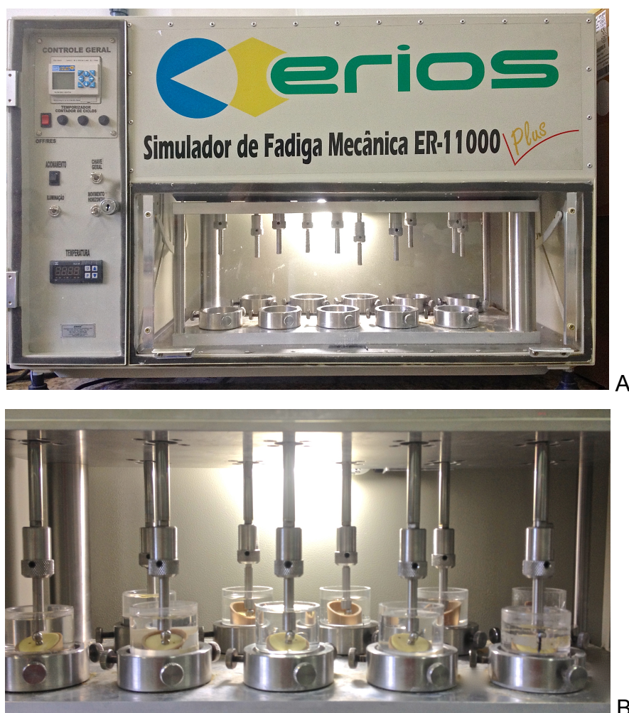
Figura 25 – A) Simulador de Fadiga Mecânica (Erios) utilizada; B) Conjuntos fixados ao dispositivo rígido de fixação da cicladora mecânica.
