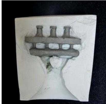
Figura 27- Remoção parcial do revestimento com martelo pneumático.
