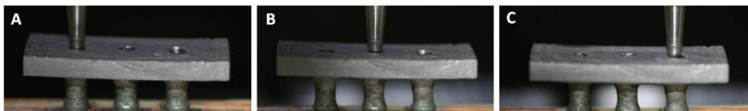
Figura 36 – Pontos de aplicação de carga axial A, B e C.
