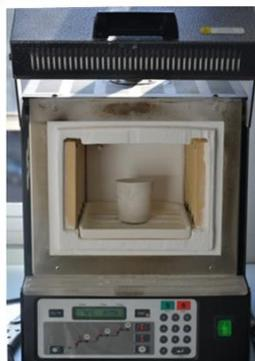
Figura 25- Aquecimento em patamares do bloco de revestimento para correta volatilização da cera e resina.
