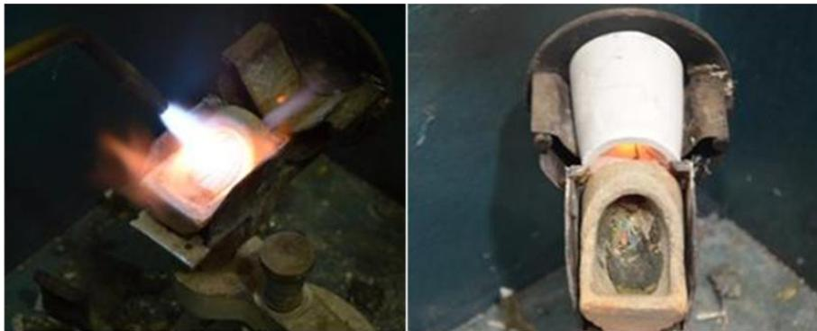
Figura 26- Fundição e injeção da liga metálica Ni-Cr em centrífuga convencional.
