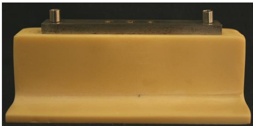
Figura 9- Index para padronização das perfurações perpendiculares posicionado sobre o bloco em poliuretano.
