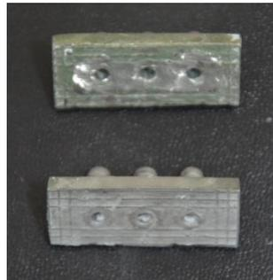
Figura 28- Acima: estrutura antes do acabamento. Abaixo: estrutura após o acabamento.
