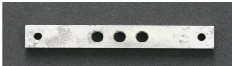
Figura 8- Index para padronização das perfurações perpendiculares.
