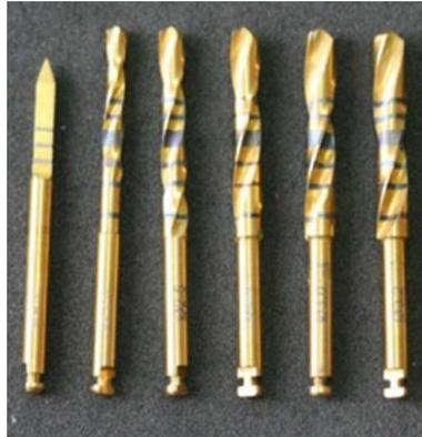
Figura 7- Fresas helicoidais utilizadas nas perfurações: lança; 2.0 mm; 2.5 mm; 2.8 m 3.0 e 3.2 mm.
