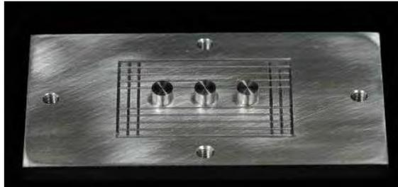
Figura 15 Componente 1 da matriz metálica utilizada para obtenção dos padrões em resina .
