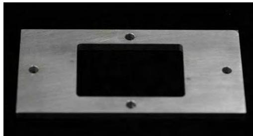
Figura 16- Componente 2 da matriz utilizada para obtenção dos padrões em resina.
