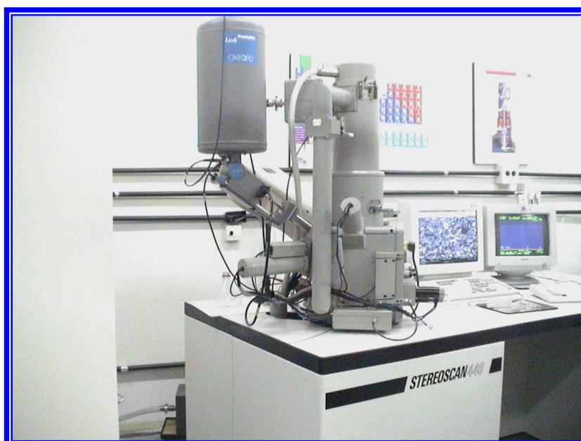
**Figura 4.1:-** Microscópio Eletônico de Varredura Stereoscan 440
