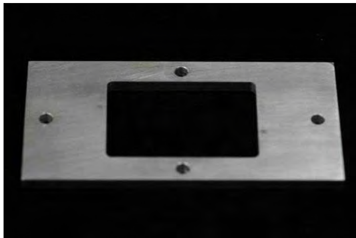
Figura 16- Componente 2 da matriz utilizada para obtenção dos padrões em resina .
