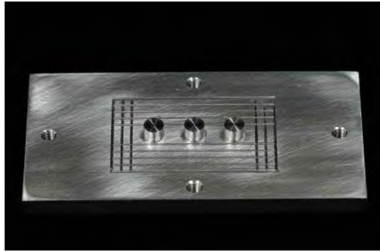
Figura 15- Componente 1 da matriz utilizada para obtenção dos padrões em resina .
