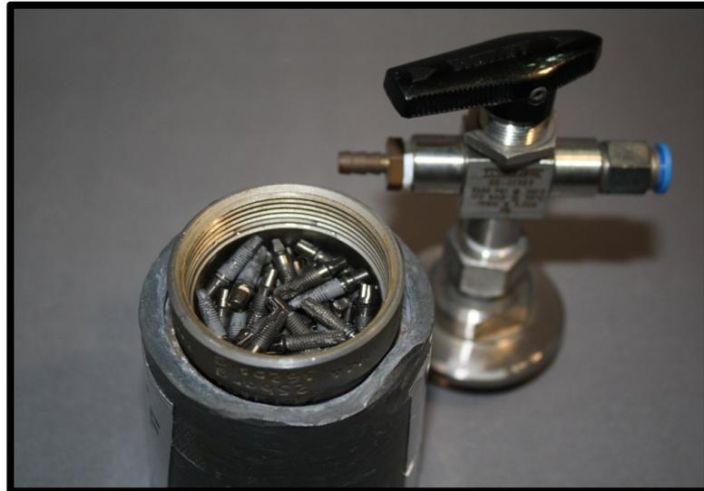
Figura 4.3 - Conjuntos implante-pilar intermediário imersos na solução contendo radioisótopo no interior da câmara
