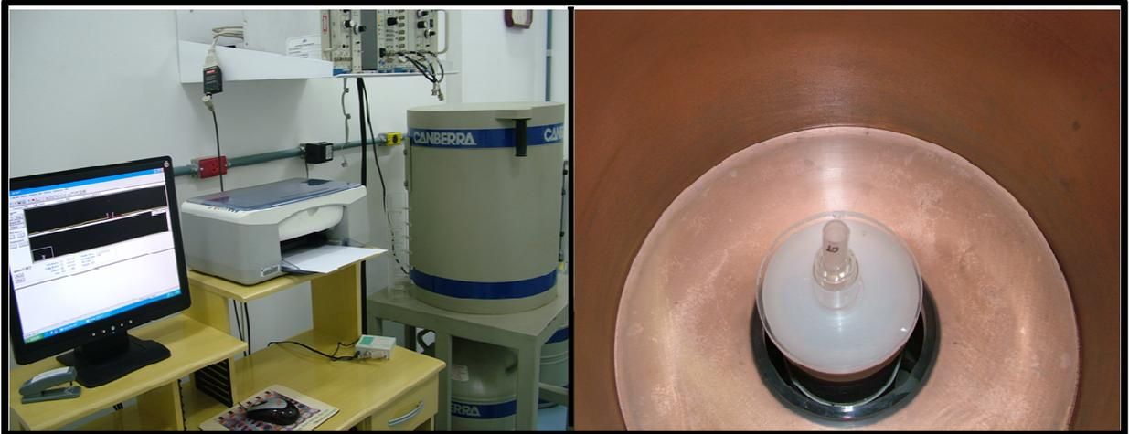
Figura 4.7 - Detector coaxial de germânio hiper puro acoplado ao sistema de aquisição multicanal (A). Em detalhe, tubo de ensaio, contendo ponta de papel absorvente utilizada na coleta do material presente no interior do implante, posicionado no detector (B)
